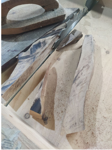
Joonis 3: Väga hea. Nüüd on mõlema puuoksaks kaks külge sirged. Kontrollisin, kuidas lõigata kolmas joon. Kasutasin kelku sirgeks lõikamiseks. Lõikamine oli raske, kuna õunapuu on väga kõva. Tera põletati puud ja jäeti mustad jäljed.
