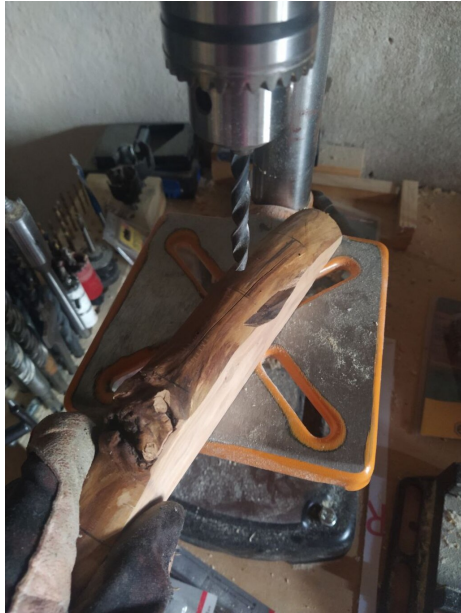
Joonis 9: Tegin augu puuriga. See ei olnud lihtne, sest ülemine osa ei ole sirge. Osa liikus väga kergesti. Aga see ei olnud oluline, sest puuriteravik oli veidi väiksem.
