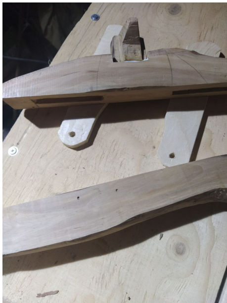
Joonis 16: Liimisin alasid selle kohale. Ma kasutasin 6 mm puust pulka, et seda kohapeal tugevdada.
