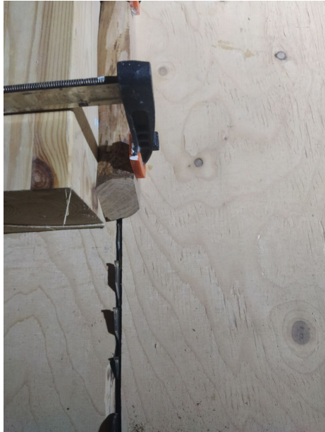
Joonis 17: Allosas peab olema auk, kuhu jalad ühendatakse. Ma tegin selle lauasae ja kelgu abil. Aga see oli jälle raske, sest puit on nii kõva.
