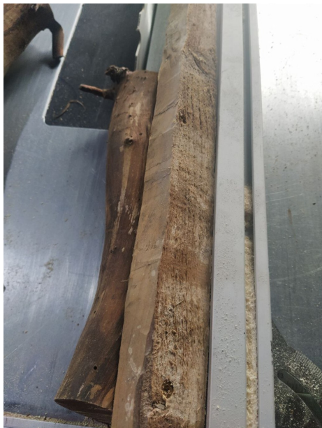
Joonis 2: Kõverad oksad tuleb sirgeks ajada. Kruvisin laua oksa külge kinni. Kasutasin trellii ja lauasaagi.
