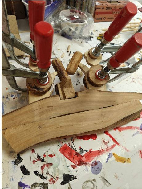
Joonis 21: Liimi pea ja kõht oma kohale. Seal on näha minu ebaõnnestunud löige. Lõikasin 6 mm puidust teljed ja saag oli natuke halb. Seega on vertikaalsed jooned selgelt nähtavad. Ma suutsin need liivapaberiga peita.
