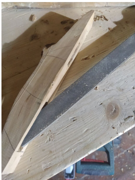
Joonis 12: Samuti pidin kasutama viili, et auku suuremaks teha ja see kulgeb sujuvamalt.
